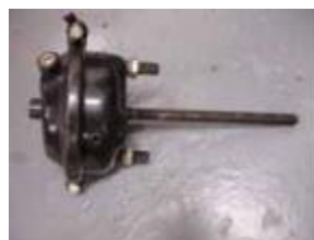
Тормозная камера рабочей тормозной системы без энергоаккумулятора
