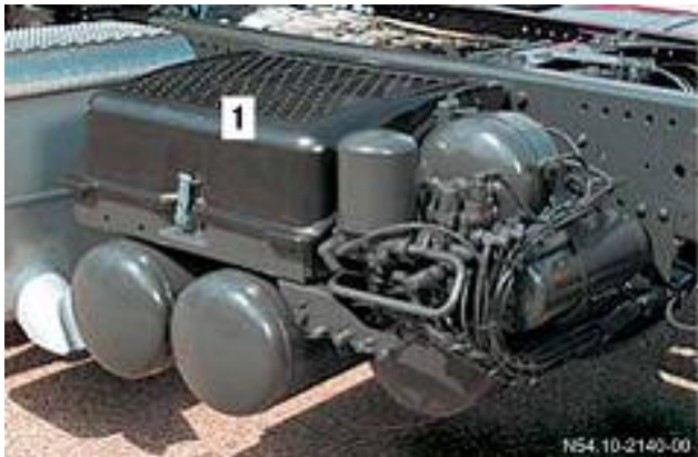
Аккумулятор расположен за кабиной со стороны водителя
