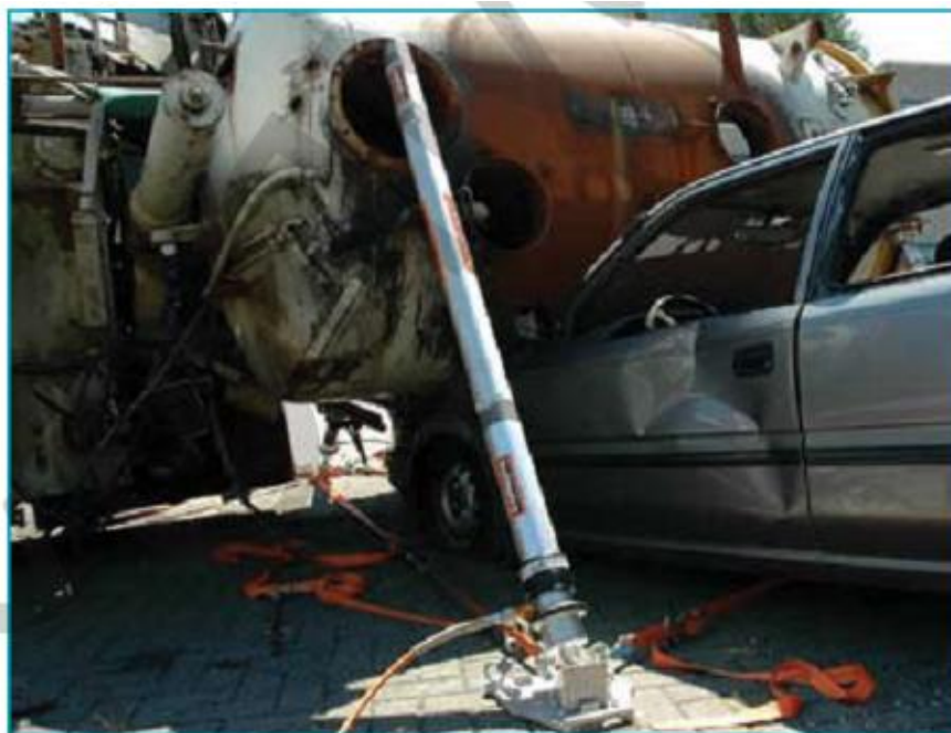
Гидравлическая распорка с фиксатором используется для одновременного закрепления и подъёма
