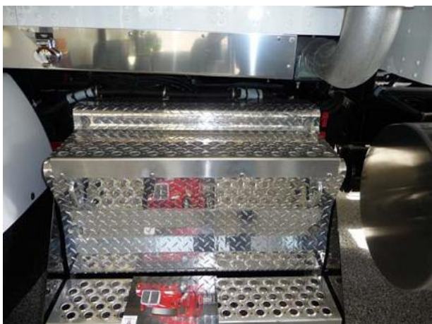
Аккумулятор расположен под ступенькой кабины
