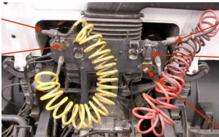
Желтый провод - управляющая или тормозная магистраль Красный провод - питающая или аварийная магистраль
