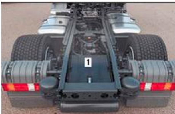
Аккумулятор расположен в конце рамы между направляющими
