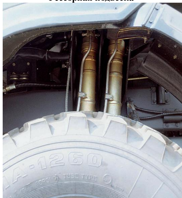
Подвеска с гидропневматическими стойками
