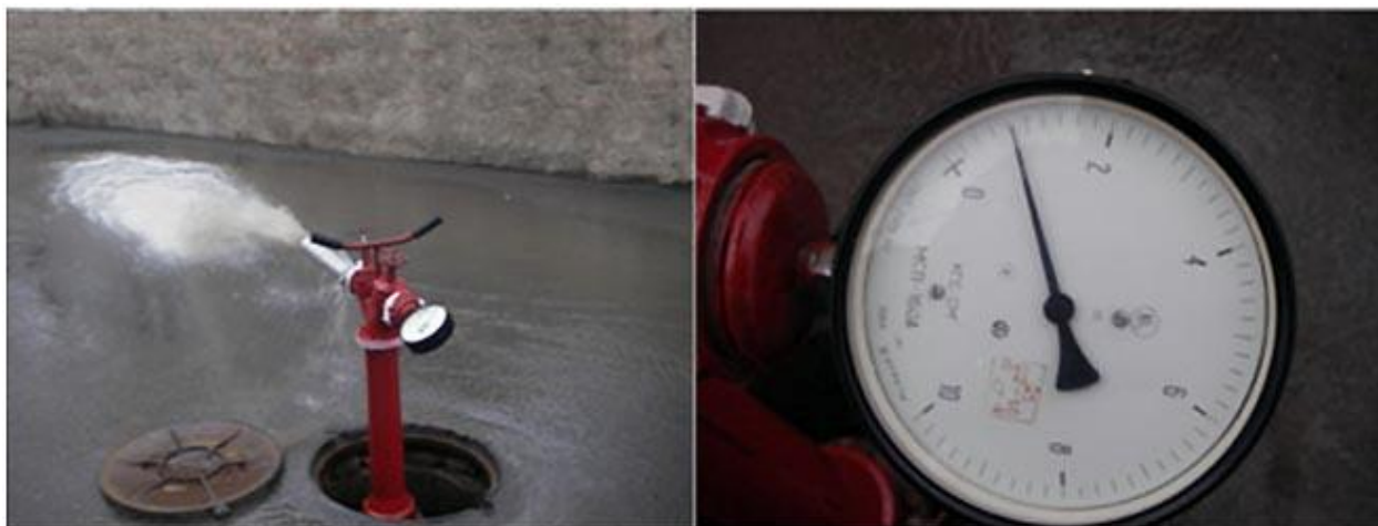
Рисунок 3. Устройство с открытым вентелем на подачу воды на гладкий патрубок
