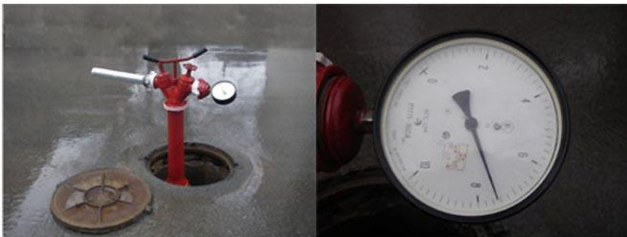
Рисунок 2. Устройство с открытым вентелем на подачу воды на манометр
