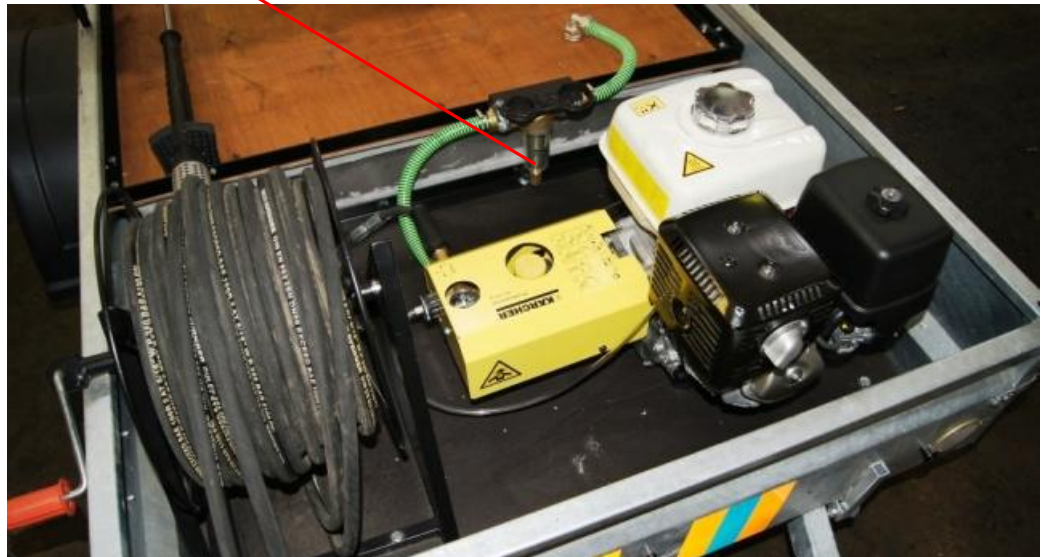
Рис. 3.14 Подключение оборудования: заправочной помпы "Еuropump П-3000" (а, б), бака, фильтра тонкой очистки, аппарата высокого давления и шланга высокого давления (на катушке) (в)
