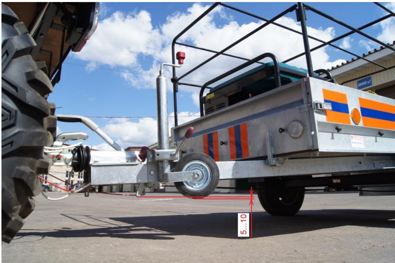
Рис. 5.4 Оптимальное транспортное положение опоры прицепа
