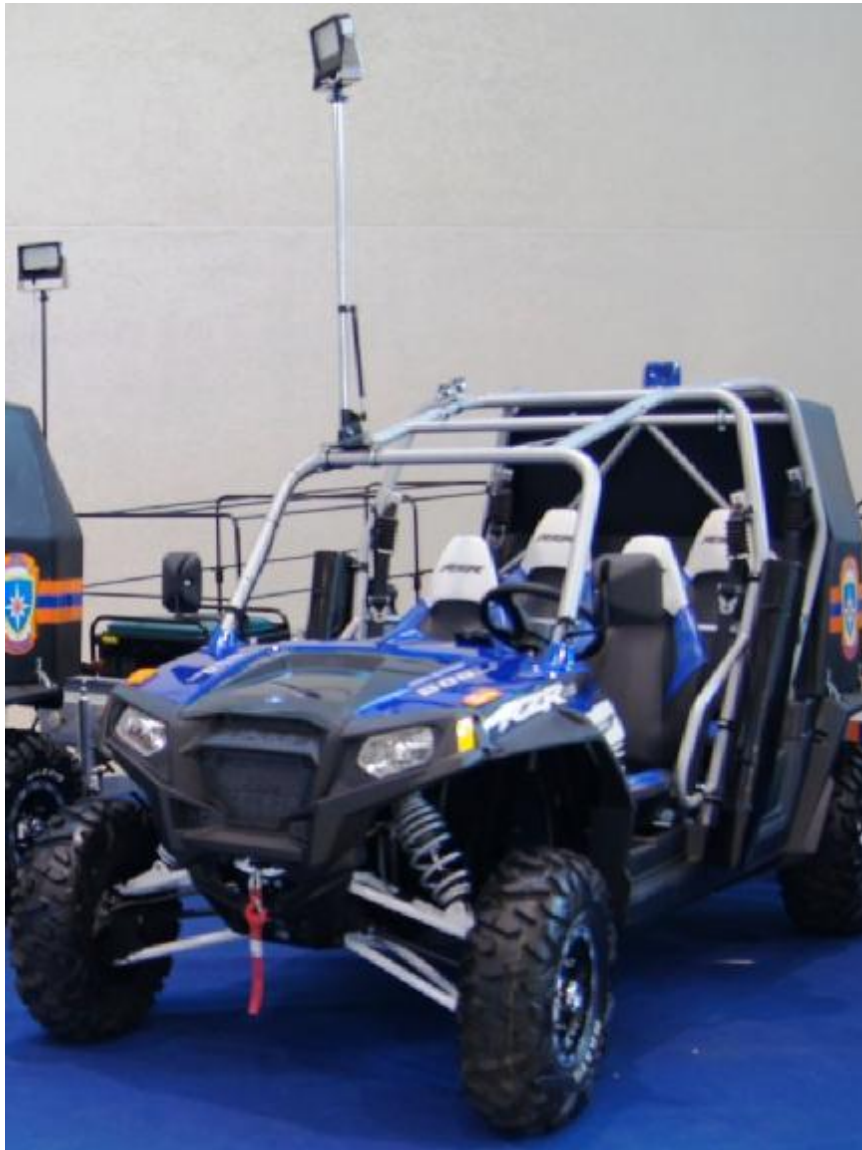
Рис. 3.10 Рабочее положение светодиодного прожектора Москва М1-24-WL-12 для освещения места проведения работ. Крюк лебедки с тяговой лентой (красного цвета).
