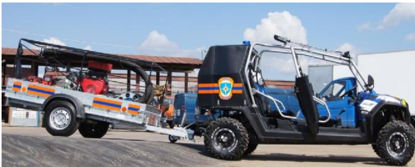
Рис. 5.2 Прохождение препятствия составом (критический просвет под дышлом прицепа)
