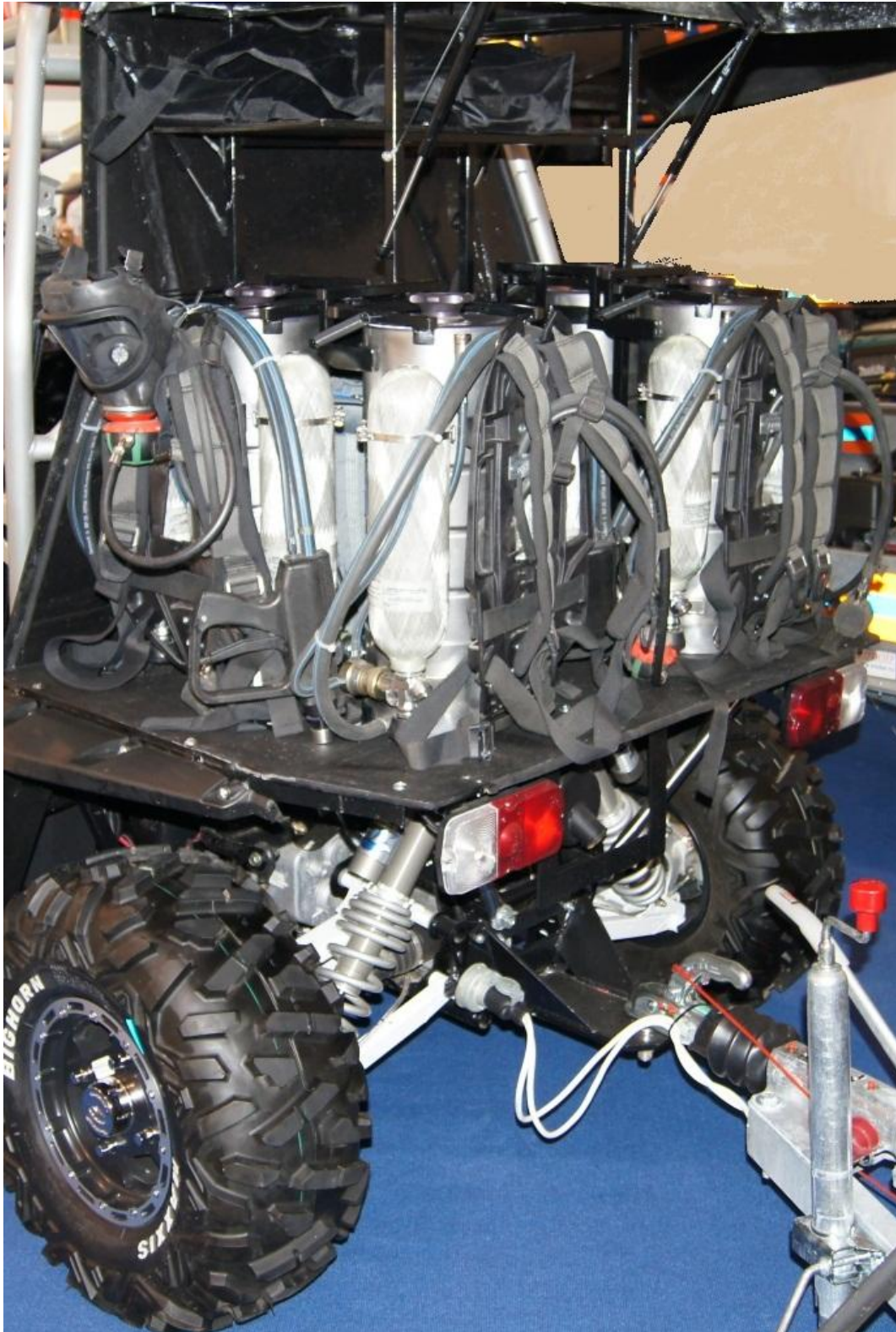
Рис. 3.3 Багажник мотовездехода с устройствами пожаротушения РУПТ-1-04 «Игла». Над ранцевыми устройствами расположена полка с лицевыми масками дыхательной системы MSA AUER в защитных чехлах. Пружинные прижимы опущены, страховочная стяжка не показана.
