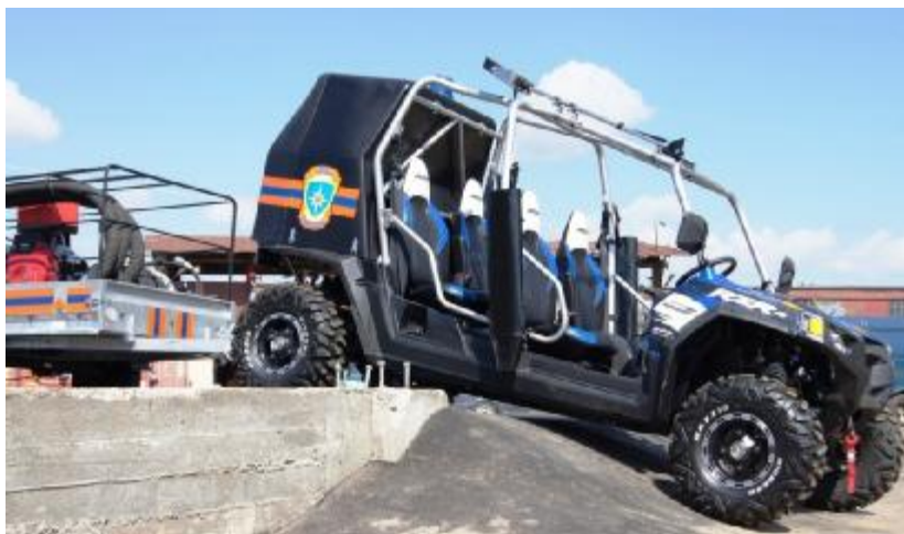
Рис. 5.1 Прохождение препятствия мотовездеходом (критический просвет под днищем)
