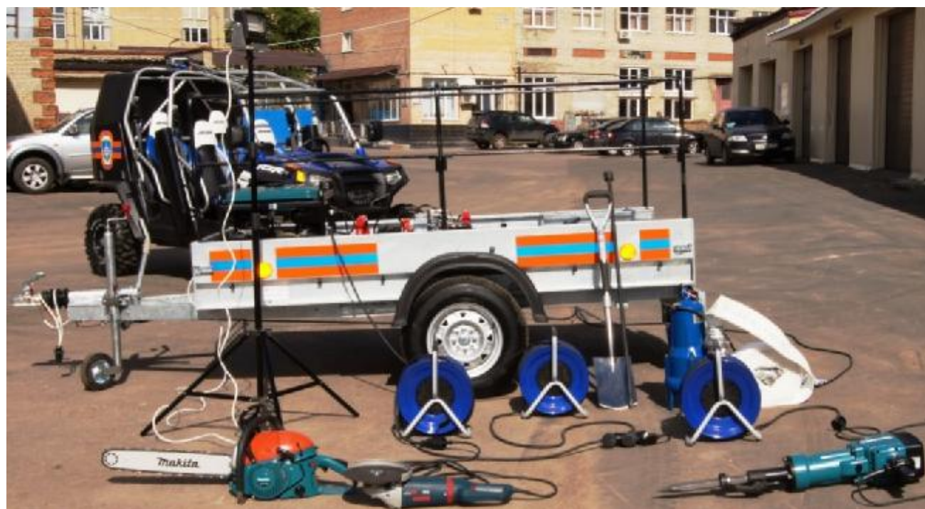
Рис. 3.21 Оборудование состава МВПС-ПО-А: бензопила, прожектор на штативе, удлинители, лопата, лом, дренажный насос, отбойный молоток
