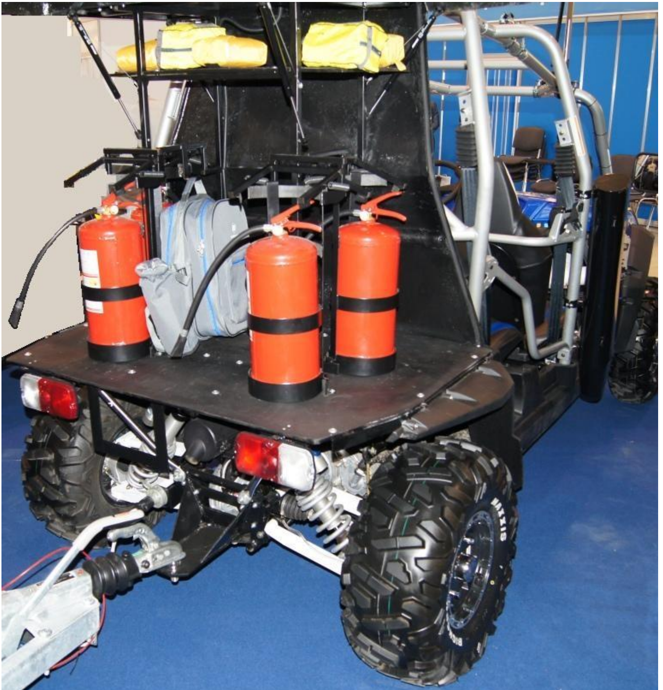
Рис. 3.5. Багажник мотовездехода с огнетушителями ОП-8з "Элит" (А, В, С) и рюкзаком. На полке над огнетушителями могут быть расположены пожарно-спасательные комплекты «ШАНС 2».
