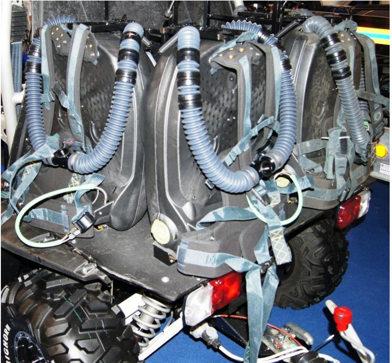
Рис. 3.4. Багажник мотовездехода с дыхательными аппаратами АП "Альфа". Пружинные прижимы опущены, страховочная стяжка не показана.
