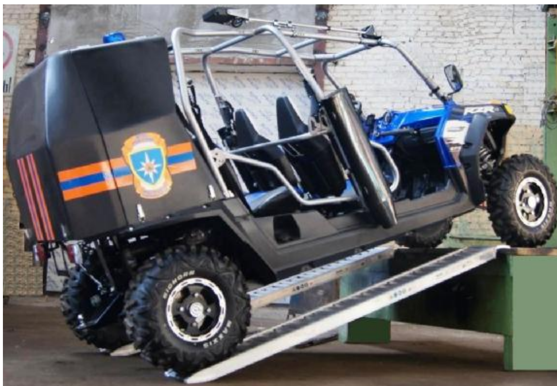
Рис. 4.1. Применение пандуса для погрузки (разгрузки) грузовой платформы (кузова автомобиля)
