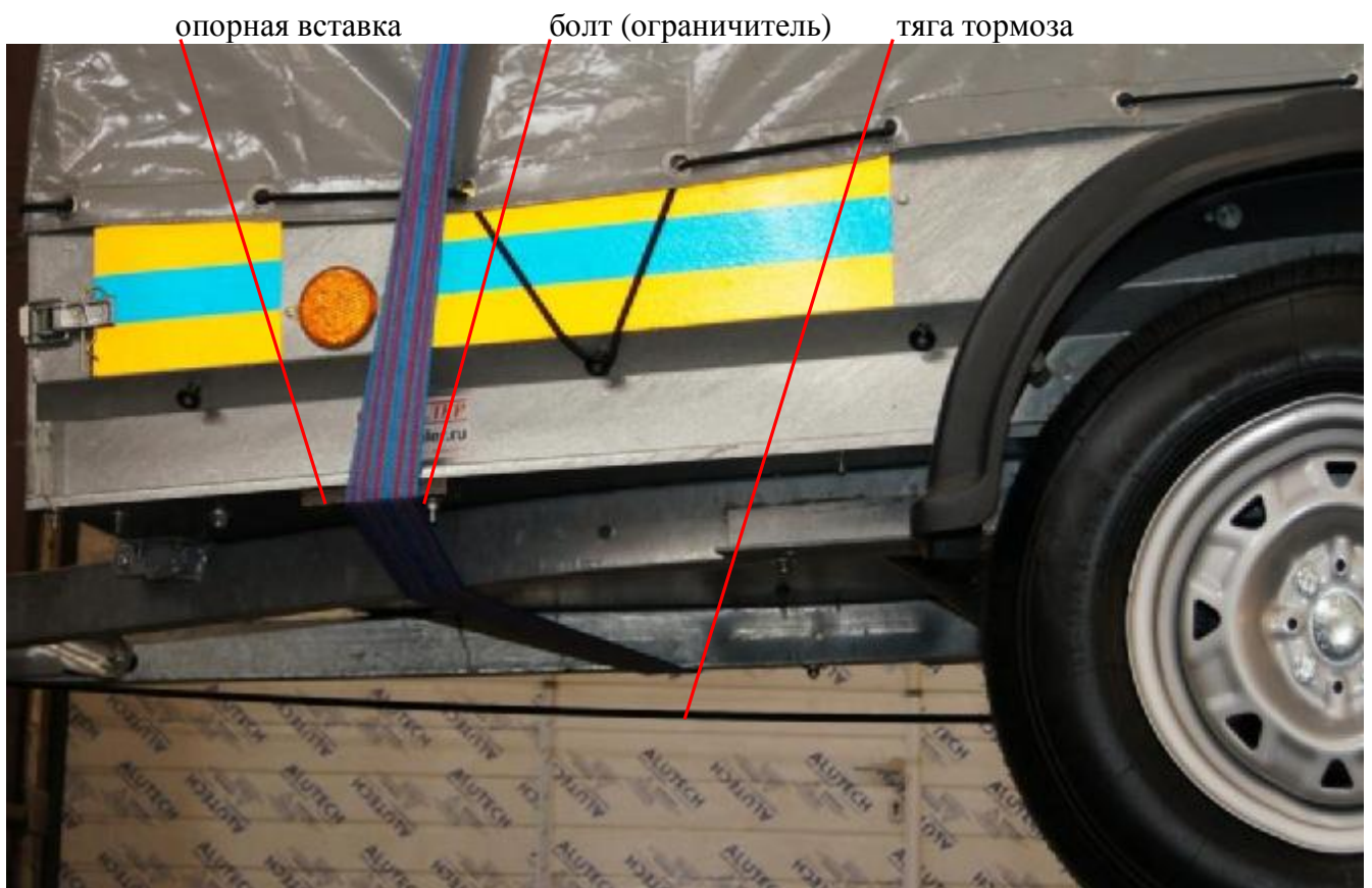
Рис. 4.4 Прокладка строп под заднюю (а) и переднюю (б) части прицепа
