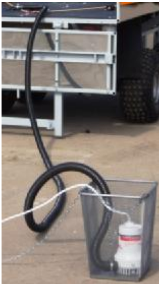
Рис. 3.14 Подключение оборудования: заправочной помпы "Еuropump П-3000" (а, б), бака, фильтра тонкой очистки, аппарата высокого давления и шланга высокого давления (на катушке) (в)
