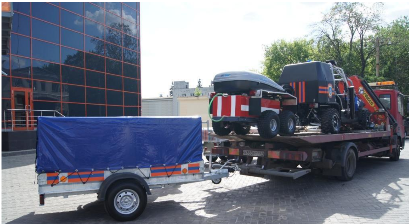
Рис. 4.5 Пример транспортировки прицепа автомобилем на тягово-сцепном устройстве эвакуатора
