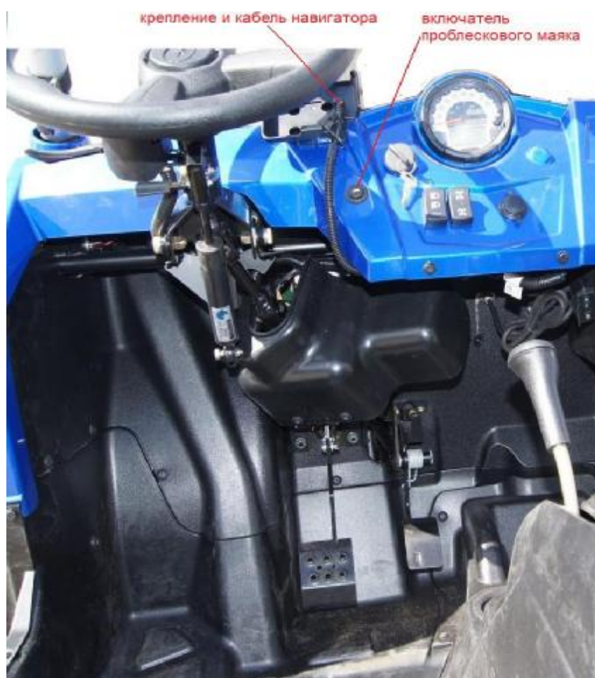
Рис. 3.12 Дополнительные элементы передней панели мотовездехода
