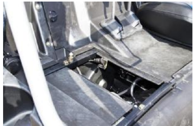
Рис. 3.11 Расположение щупа двигателя (а), щуп вытянут, фиксатор открыт (б) щуп вытянут, фиксатор закрыт (в)
