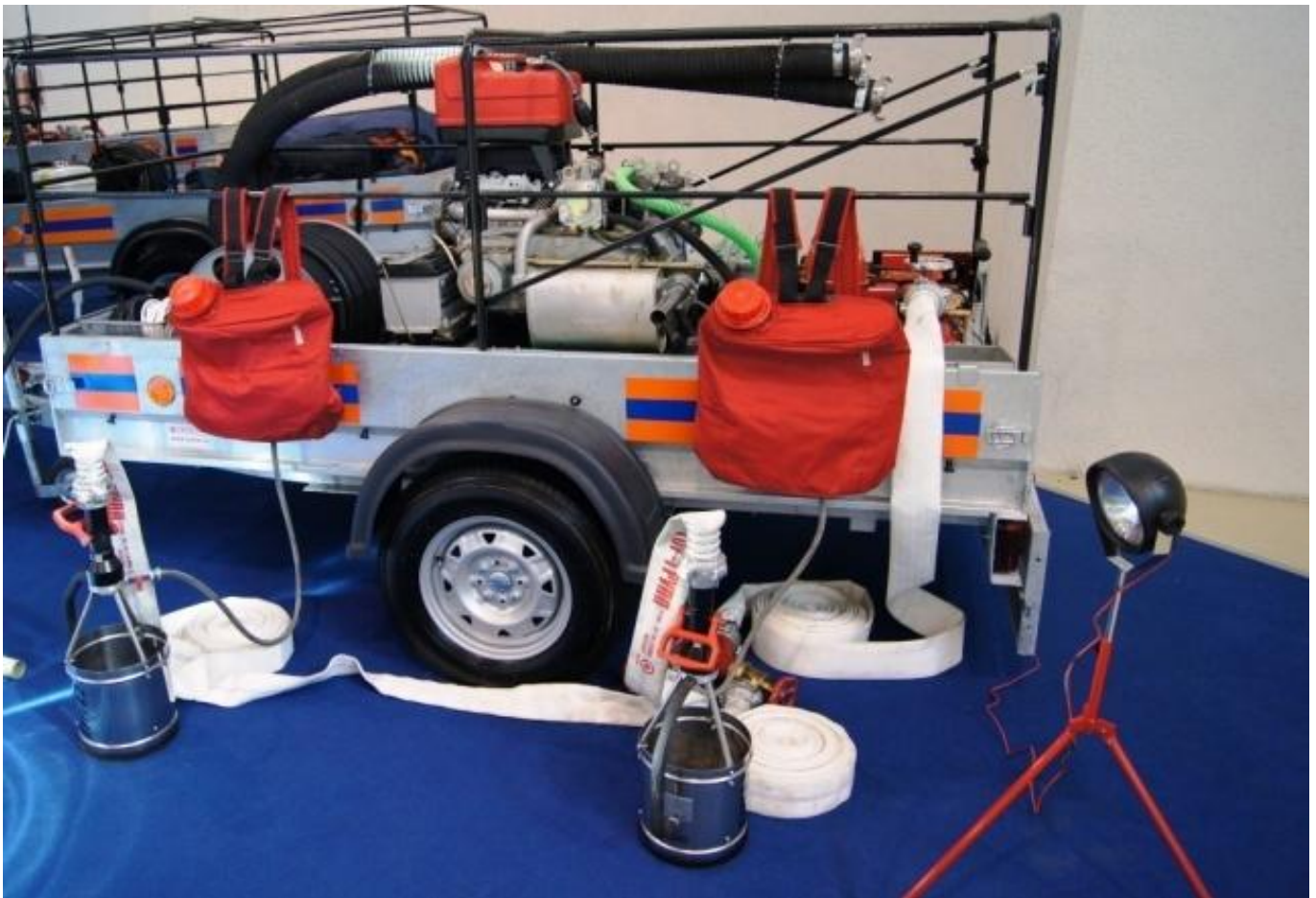
Рис. 3.18 Прицеп состава МВПС-ПО-П с оборудованием: подключение стволов УКТП «Пурга-2» к рукавам и ранцам, прожектор.
