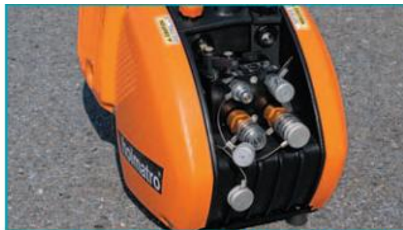
установка пылезащитных колпачков
