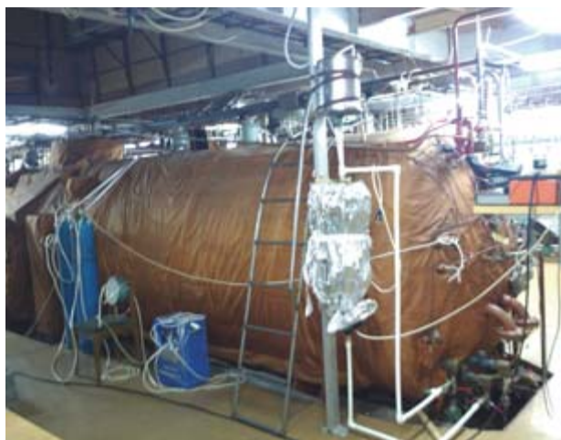
Рис. 6. Внешний вид экспериментальной установки по выявлению зависимости показаний термомагнитного датчика от давления газовой смеси с помощью трехотсечной барокамеры в составе глубоководного водолазного комплекса ГВК-250
