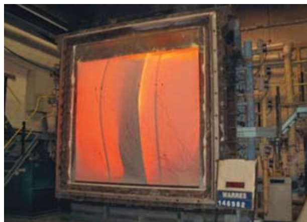
Рис. 25. Камера для проведения огневых испытаний противопожарных штор
