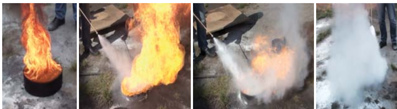
Рис. 5. Фрагменты процесса тушения пламени бензина огнетушащим порошком со средним размером частиц 110 мкм
