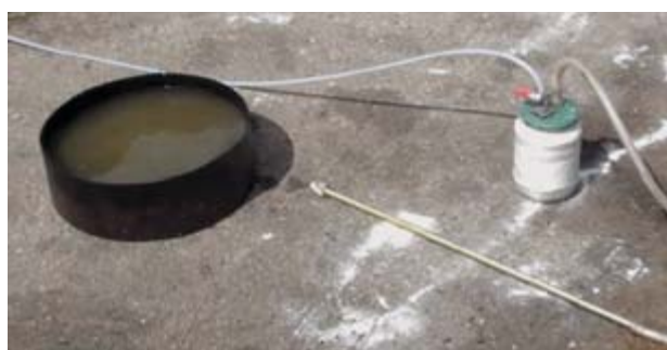
Рис. 2. Основные элементы установки для испытания огнетушащей способности порошка
