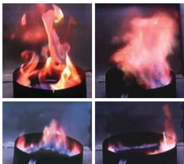
Рис. 4. Фрагменты процесса тушения пламени этилового спирта распыленной струей фреона 114B2 со средним размером капель 80 мкм
