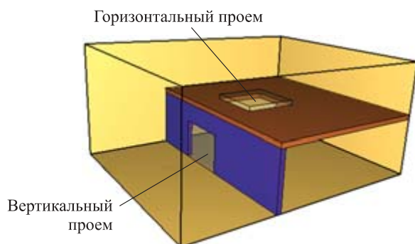
Рис. 7. Вертикальный и горизонтальный проемы
