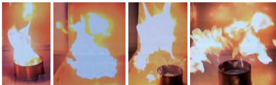
Рис. 2. Фрагменты процесса тушения пламени гептана распыленной струей фреона 114B2 со средним размером капель 80 мкм
