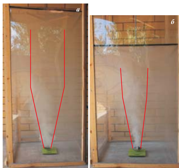
Рис. 4. Характерные фотографии течения внутри экспериментального объема при расположении горючего материала в центре пола помещения: а — h = 1,5 м; б — h = 1,0 м
