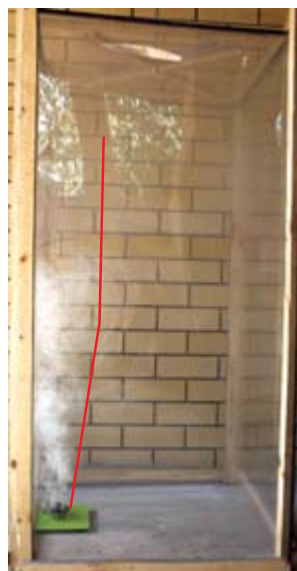
Рис. 6. Характерные фотографии течения внутри экспериментального объема при расположении горючего материала у стены ( h = 1,5 м)
