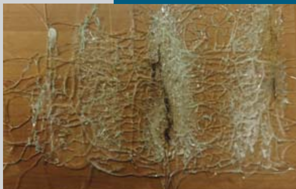
Защита триплекса при пожаре
