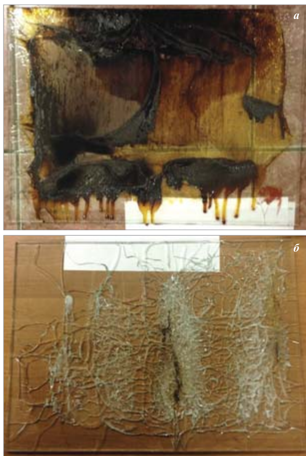
Рис. 3. Образец триплекса 6-1-6 через 45 мин после испытания без водяного орошения (а) и с орошением (б)
