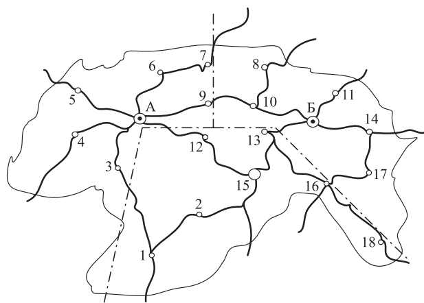
Рис. Б.5.2 Первый вариант разграничения районов обслуживания ПЧ А , ПЧ Б и ПЧ 15
