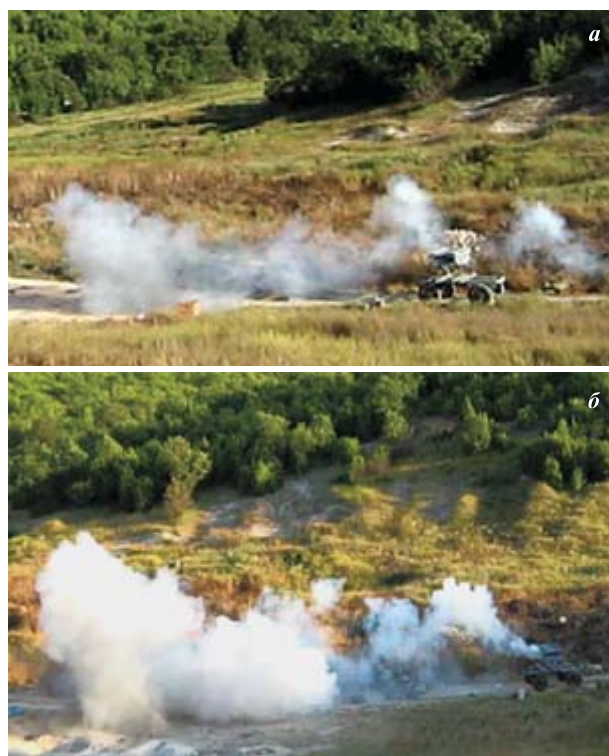
Рис. 4. Фрагменты импульсного распыления 1,5 кг биосорбента плотностью 0,15 \text{ г/см}^3 из одного ствола (а) и залпового распыления 7,5 кг биосорбента из пяти стволов (б)
