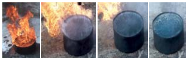
Рис. 5. Фрагменты процесса тушения дизельного топлива пленкообразующими водными растворами
