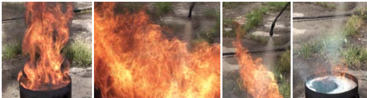
Рис. 10. Фрагменты процесса тушения бензина пленкообразующими водными растворами
