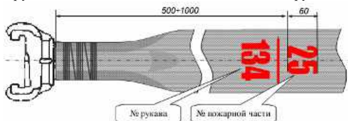
Рис. 5.3 Маркировка пожарного напорного рукава
