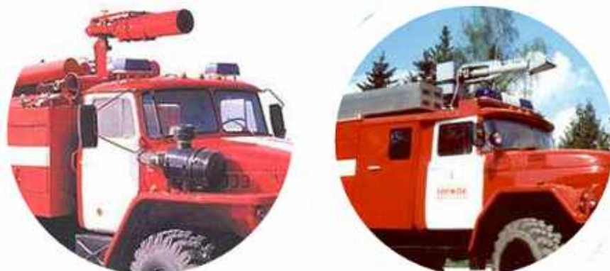
Рис. 5.18 Стационарные лафетные стволы ЛС-С-40 (слева) и ЛСД-40А (справа), установленные на пожарных автоцистернах.
