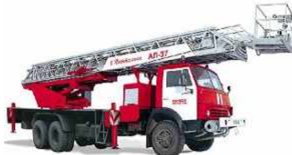
Рис. 2.30 Пожарная автолестница АЛ-37(53229)ПМ-544
