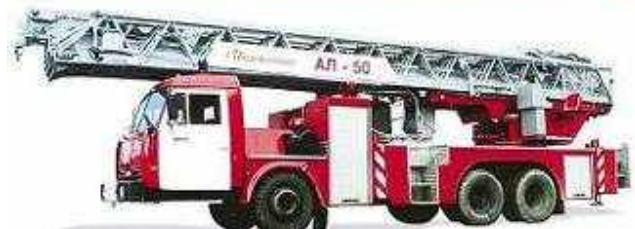
Рис. 2.31 Автолестница АЛ-50 моделей ПМ-513 (вверху) и ПМ-513А (внизу).
