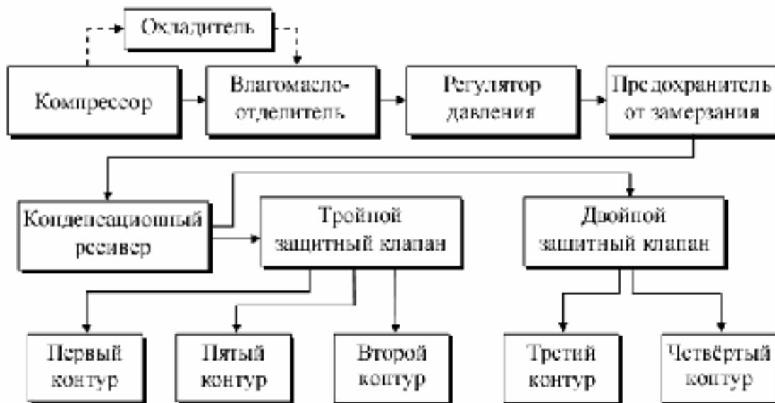
Рис. 9.8 Принципиальная схема работы питающей части пневмопривода
