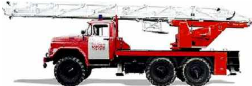
Рис. 2.28 Автолестница пожарная АЛ-30(131)ПМ-506Д
