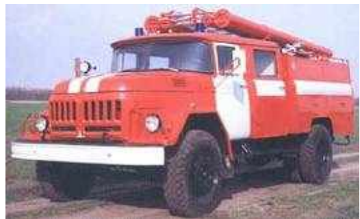
Рис.2.2.Пожарная автоцистерна АЦ-40(431410)БЗБ
