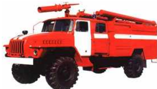
Рис.2.7.Пожарная автоцистерна АЦ-3,0-40(43206)1МИ
