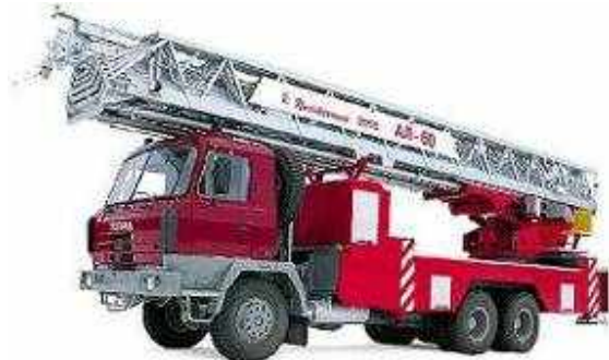
Рис. 2.32 Автолестница пожарная АЛ-62(Т815)ПМ-553
