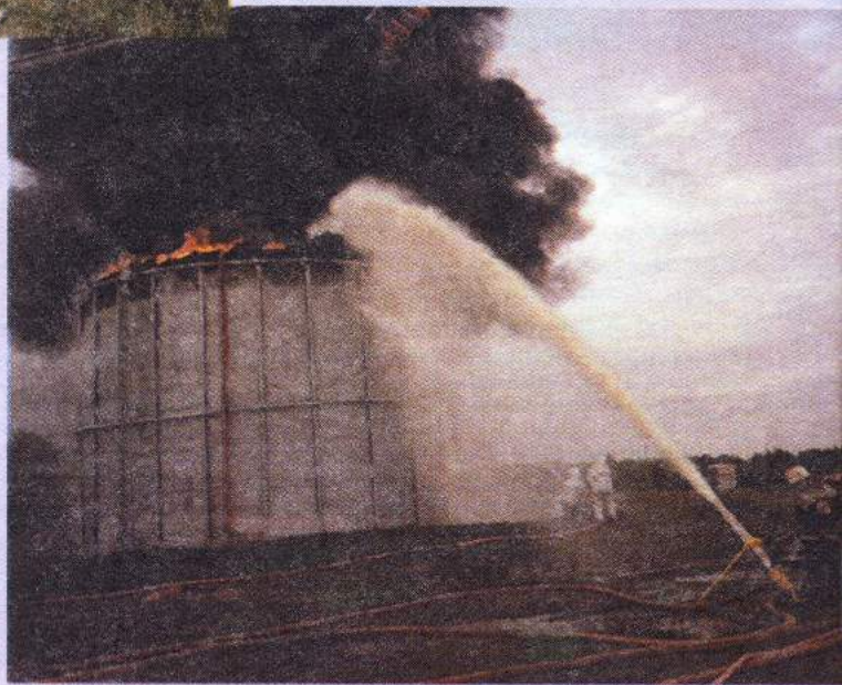
Тушение РВС-2000 с нефтью пенной навесной струей с помощью переносного монитора
