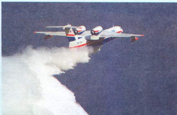
Десять тонн воды обрушиваются на горящий объект из гидросамолета Бе-200
