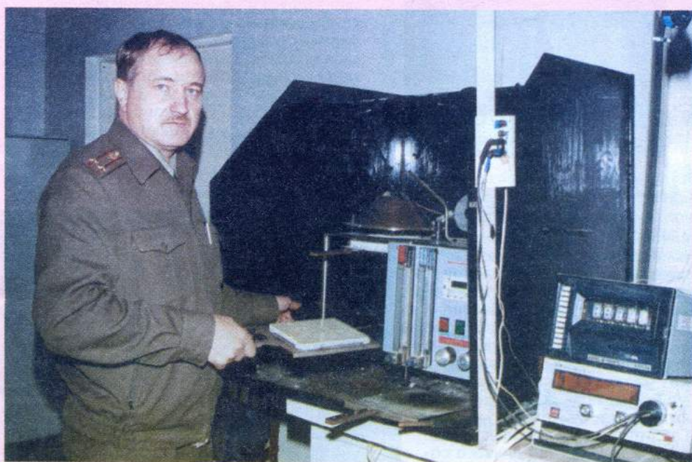
Начальник отделения сертификации В. Лапшов проводит определение воспламеняемости фрагмента наливных полов
