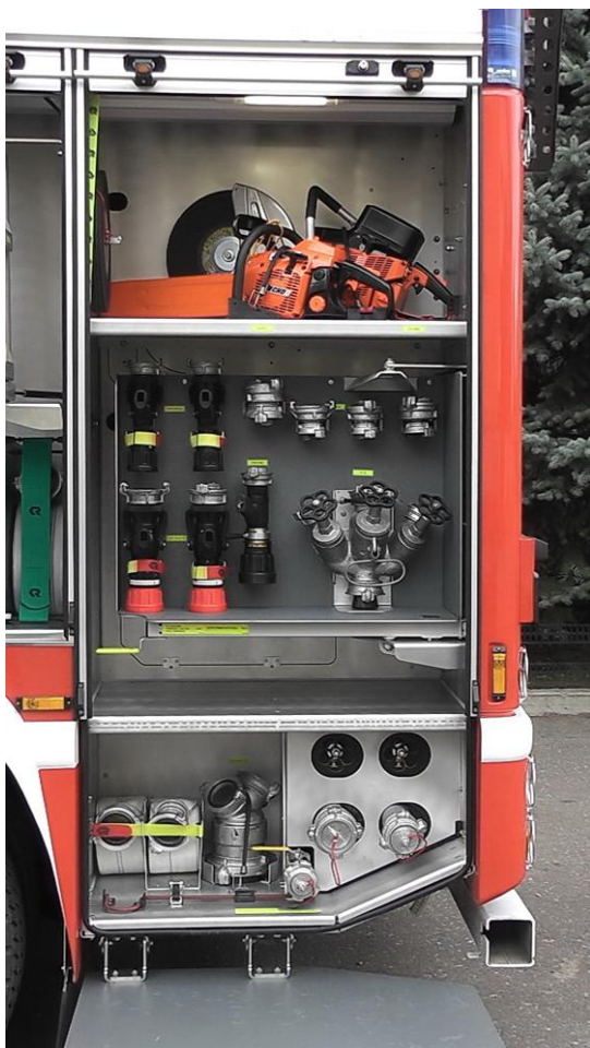
Фото 6 и 7 Размещение ПТВ в заднем отсеке по левому борту
