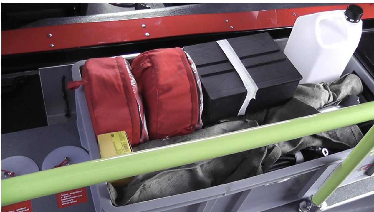
Фото 15 Размещение ПТВ в отсеке экипажа
