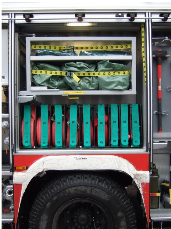
Фото 11 и 12 Размещение ПТВ в среднем отсеке по правому борту
