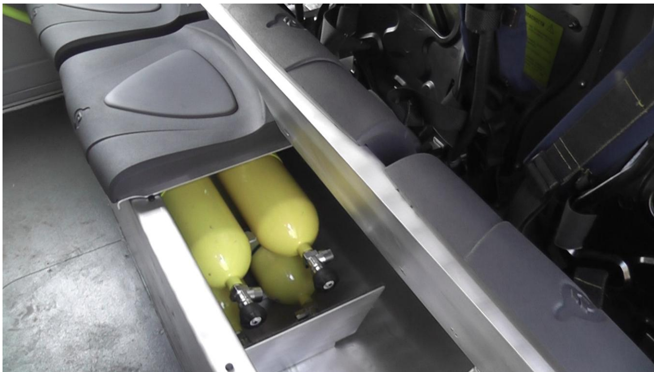
Фото 15 Размещение запасных баллонов для АИРов в отсеке экипажа
