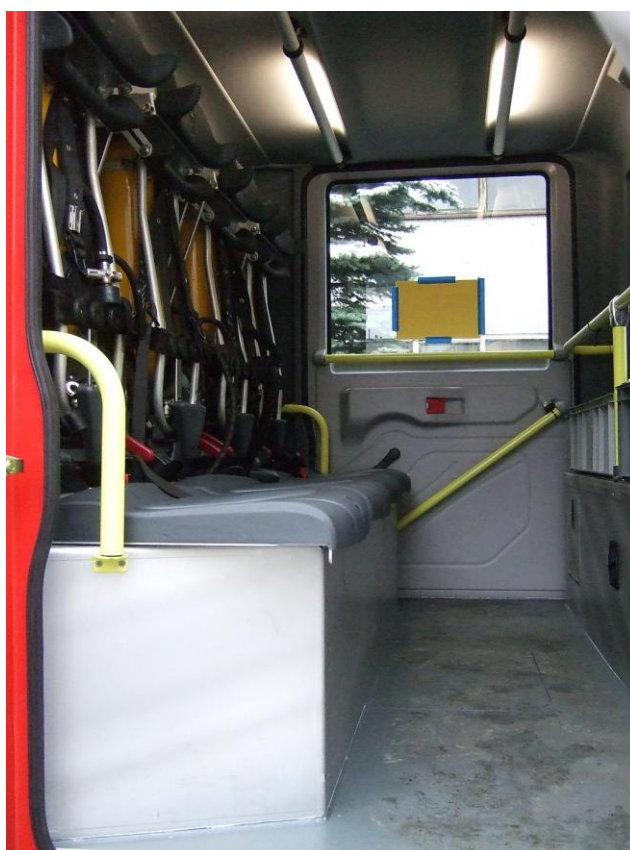
Фото 14 Размещение ПТВ (АИРов) в отсеке экипажа
