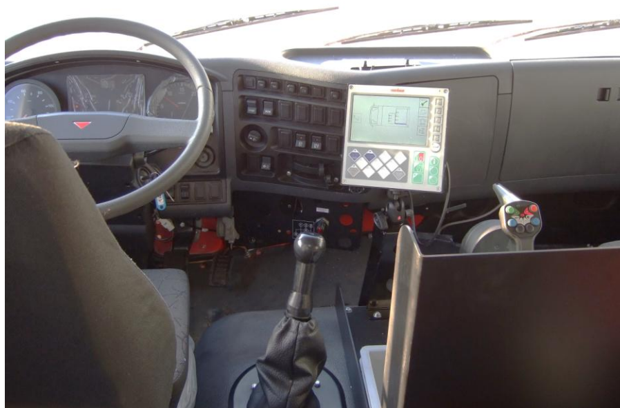
Установка дисплея в кабине водителя
