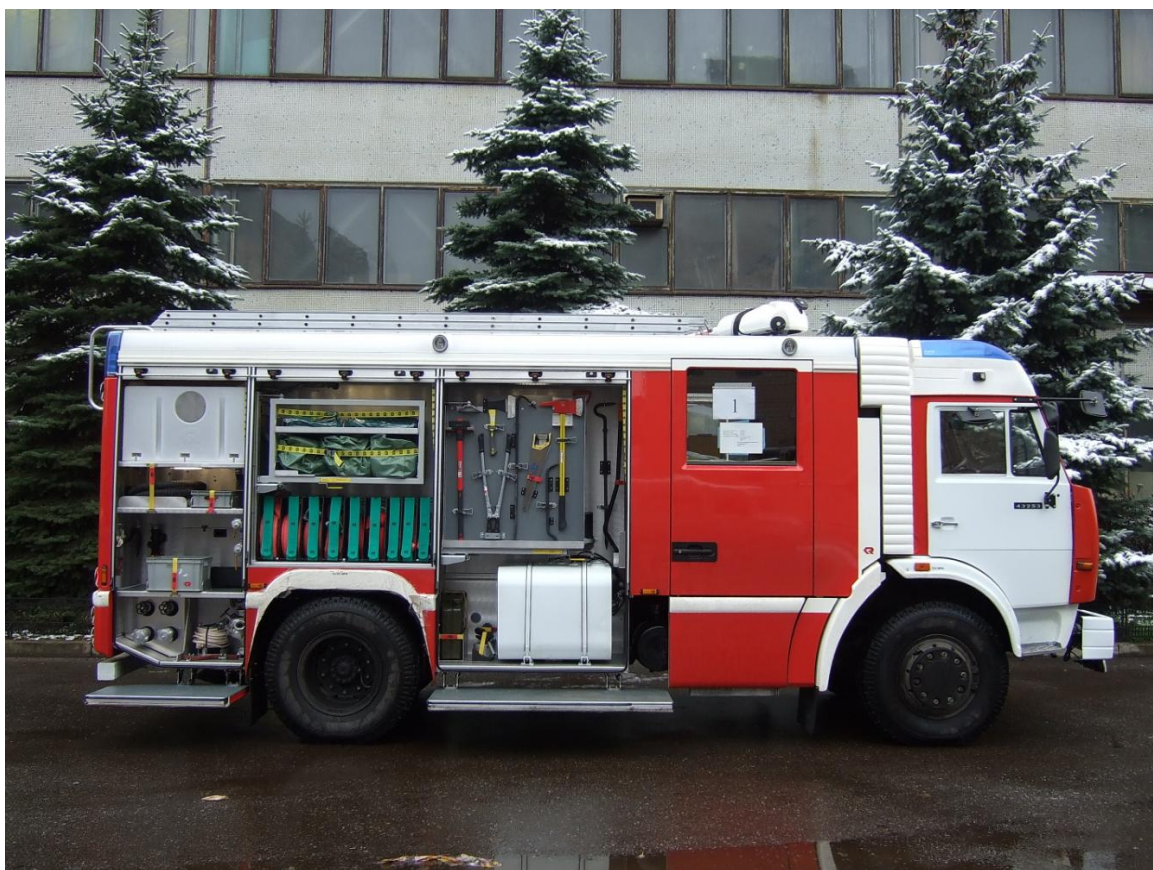
Фото 8 Размещение ПТВ по правому борту надстройки
