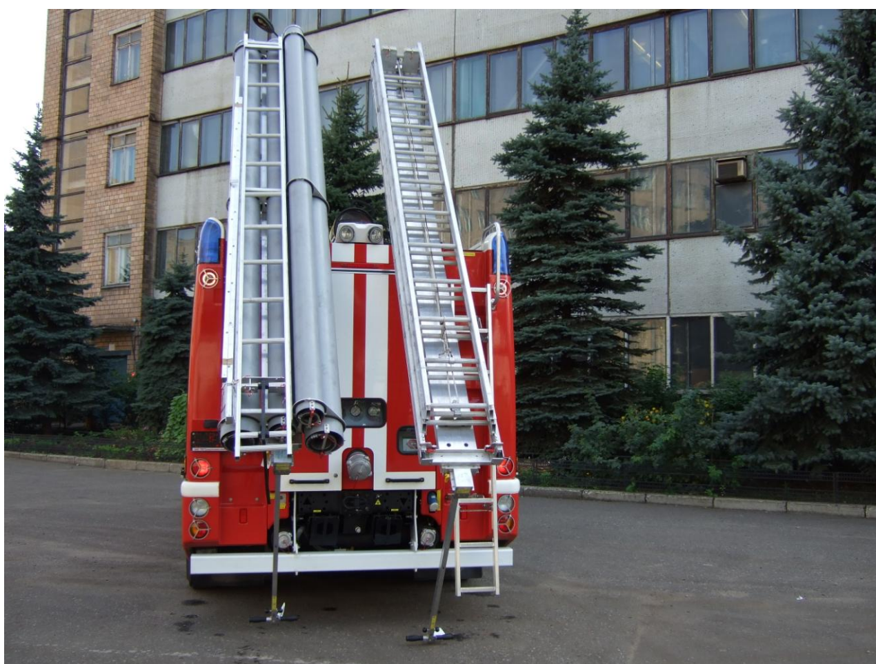
Фото 17 Крепление лестниц и пеналов с напорно – всасывающими рукавами на съемных панелях.
