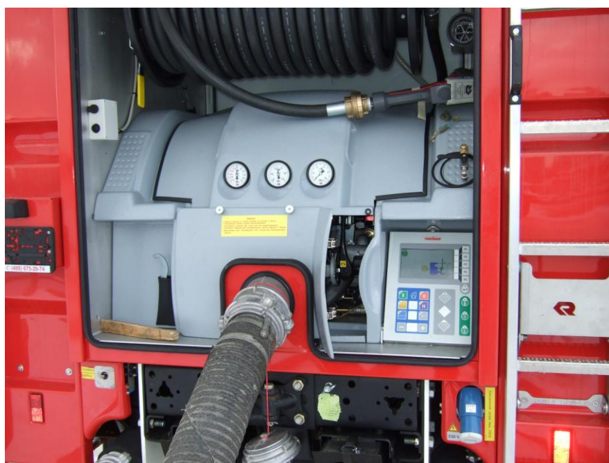
Установка дисплея в насосном отсеке
