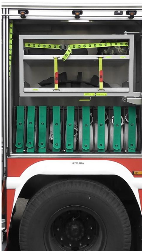
Фото 4 и 5 Размещение ПТВ в среднем отсеке по левому борту
