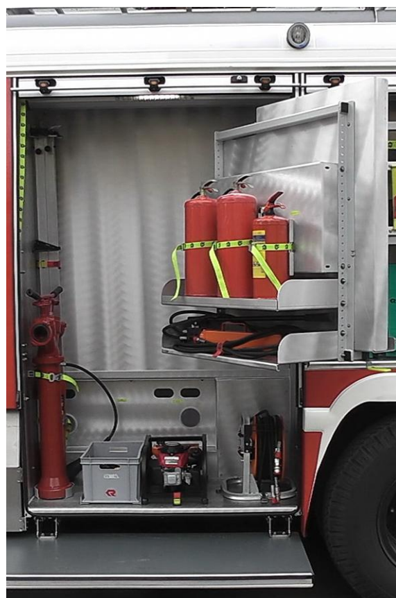
Фото 2и 3 Размещение ПТВ в переднем отсеке по левому борту
