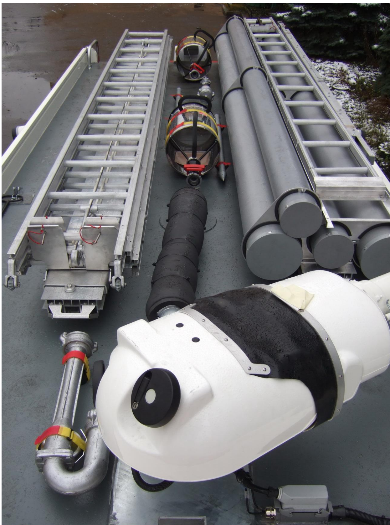
Фото 18 Размещение ПТВ на крыше пожарной надстройки
