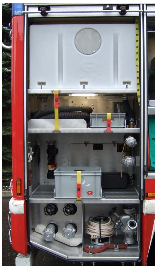
Фото 13 Размещение ПТВ в переднем отсеке по правому борту
