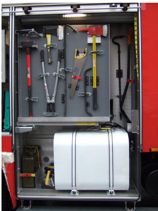
Фото 8 Размещение ПТВ по правому борту надстройки
