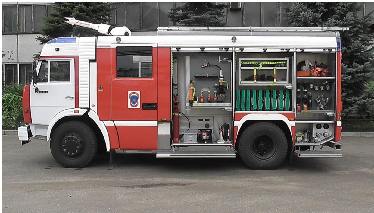
Фото 1 Размещение ПТВ по левому борту надстройки
