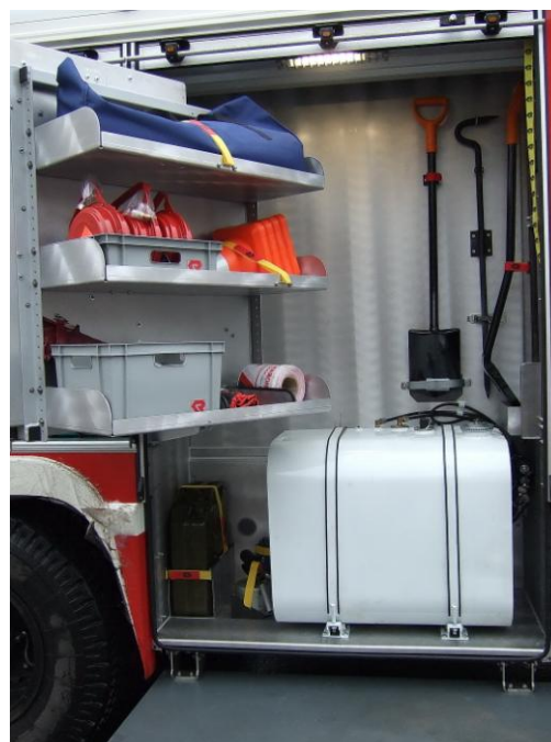
Фото 9 и 10 Размещение ПТВ в переднем отсеке по правому борту
