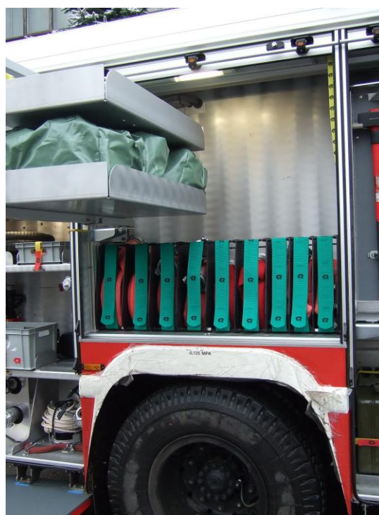
Фото 11 и 12 Размещение ПТВ в среднем отсеке по правому борту
