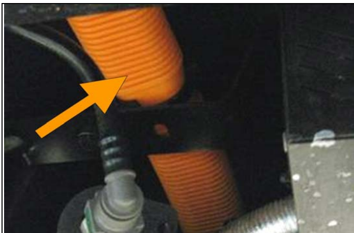
Кабель оранжевого цвета цепи с напряжением 400 В
