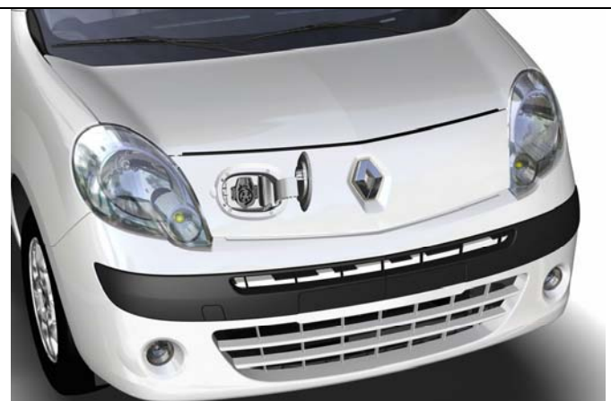
Крышка люка зарядной розетки открыта
