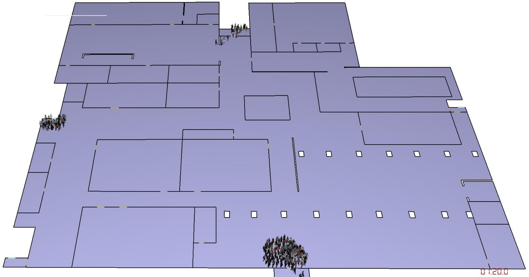
Рис. 33. Динамика движения людей на 80 секунде моделирования (Вариант 1)
