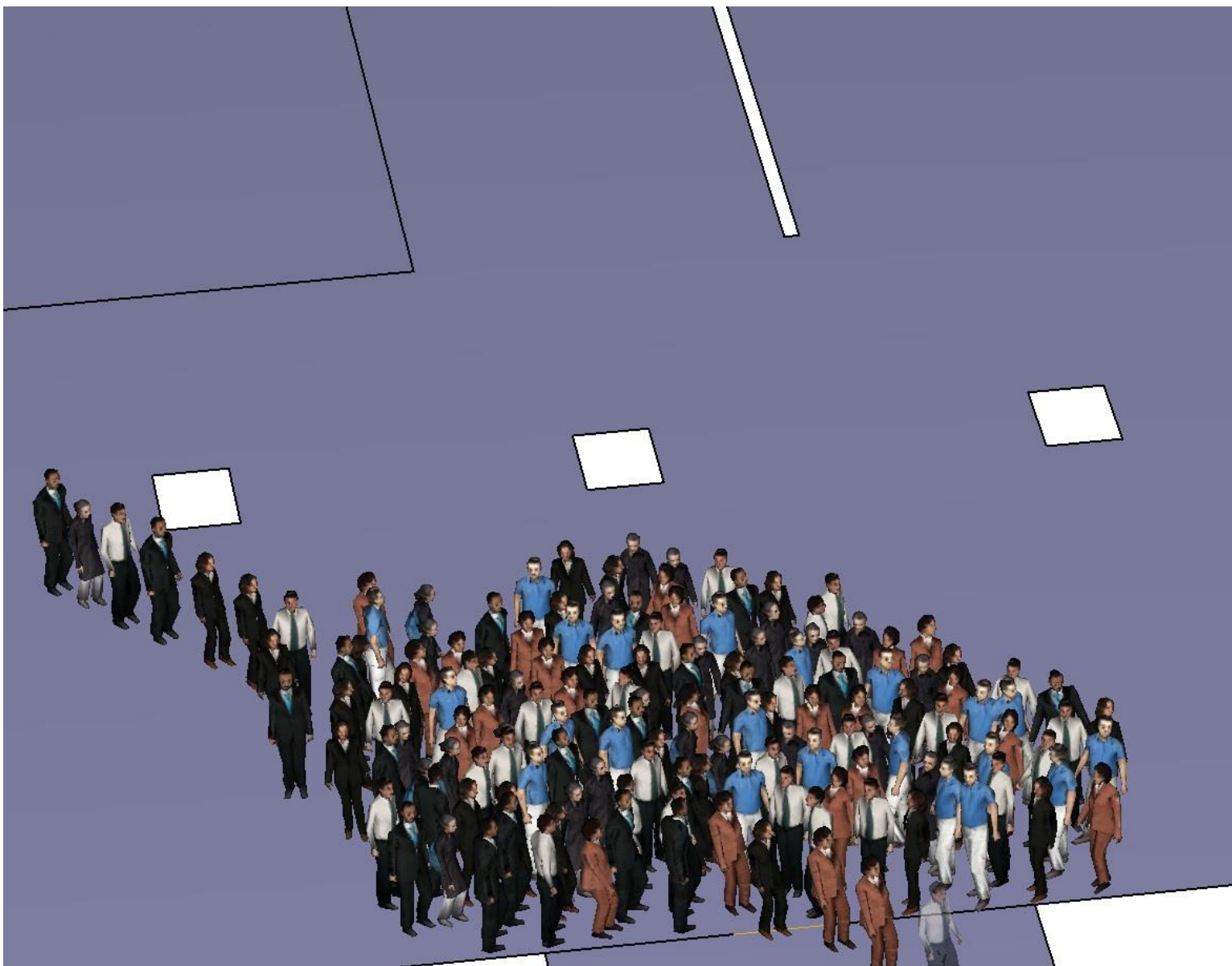
Рис. 24. Образование скоплений перед входом в лестничную клетку (Вариант 1)
