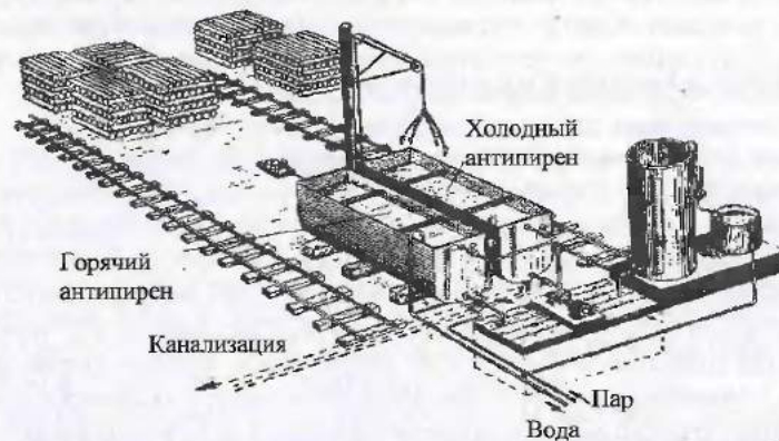
Рис. 8.3. Схема завода по пропитке древесины антипиренами по способу горяче-холодных ванн
