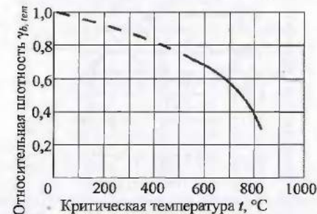
Рис. 3.22. Изменение относительной прочности тяжелого бетона класса В30 по прочности с гранитным заполнителем при нагреве в нагруженном состоянии [7, 9, 10]
