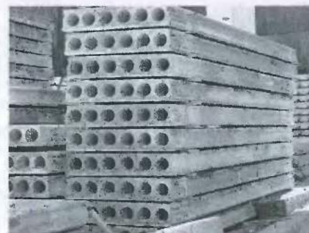
Рис. 3.7. Общий вид железобетонных плит
