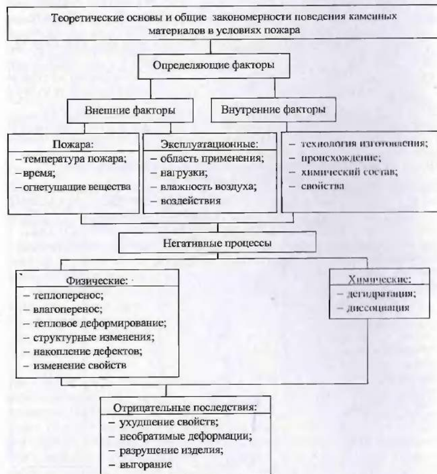
Рис. 3.1. Структурная схема-ключ к изучению, оценке, прогнозированию и регулированию поведения минеральных (каменных) материалов в условиях пожара и определению области их применения
