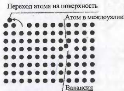
Рис. 4.4. Точечные дефекты в кристалле
