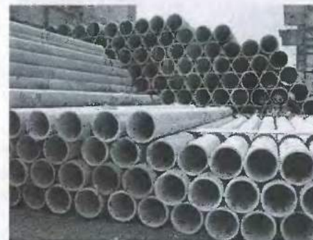
Рис. 3.8. Общий вид асбестоцементных труб
