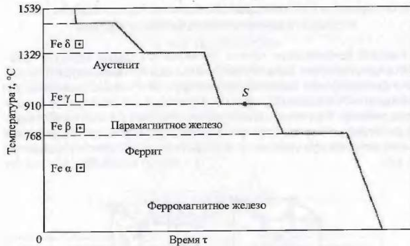
Рис. 4.3. Графическая зависимость изменения температуры от времени охлаждения для чистого железа (диаграмма аллотропических превращений чистого железа)
