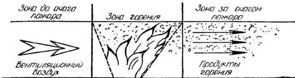
Рис. 126. Схема распространения пожара в туннеле, вентилируемом воздушным потоком
