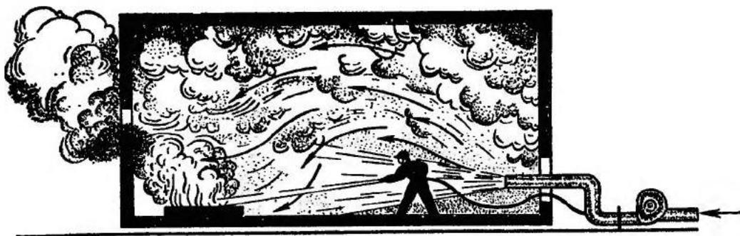
Рис. 22. Схема работы дымососа на нагнетание чистого воздуха в помещение (стрелками обозначено направление движения чистого воздуха)
