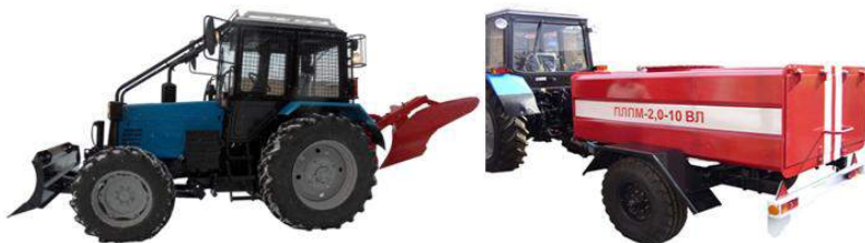
Рис. 4.4 Универсальный лесной противопожарный комплекс УЛПК-1 ВЛ в обычном исполнении (слева) и с прицепом пожарным ПЛПМ 2,0-10ВЛ
