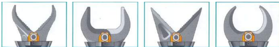
Рис. 5.1.17. Типы лезвий (ножей) гидравлических резаков
