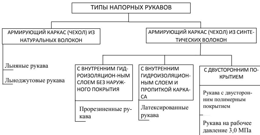
Рис. 5.3.3. Классификация пожарных напорных рукавов
