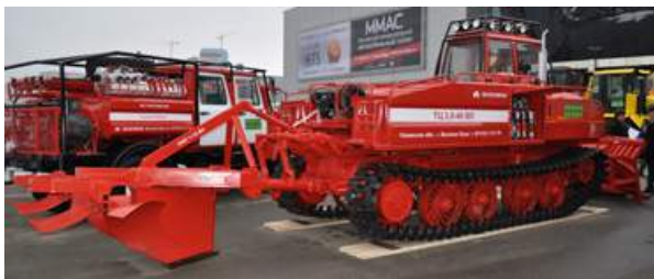
Рис. 4.3 Трактор лесопожарный ТЦ 3,0-40 ВЛ с плугом ПЛП 1-15 ВЛ
