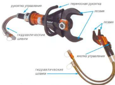
Рис. 5.1.16. Общее устройство гидравлических резаков
