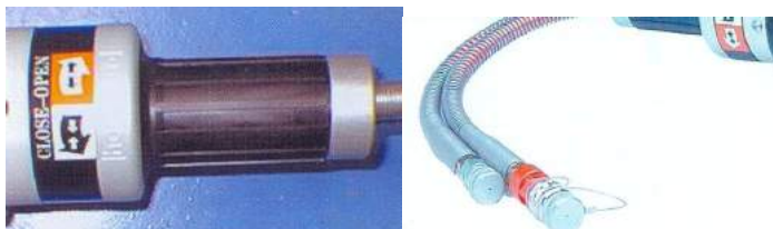
Рис. 5.1.39. Рукотка управления и гибкие шланги гидравлического инструмента
