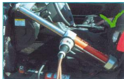
разрез каркаса сделан до начала работы домкрата
