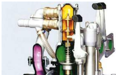
Рис. 1.4.63 Дозирующий пропорциональный клапан автоматической системой дозирования пенообразователя «FIX MIX» пожарного насоса NH-30
