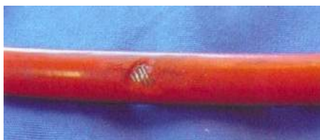
Рис. 5.1.38. Повреждённый шланг (рукав) высокого давления
