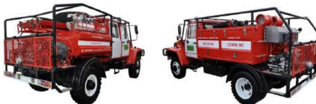
Рис. 4.18 Пожарные автоцистерны АЦ 1,6-40(33081)ВЛ (слева) и АЦ 3,0-40(33086)ВЛ (справа)
