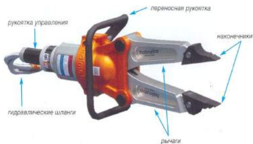
Рис. 5.1.22. Общее устройство гидравлического расширителя
