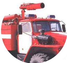
Рис. 5.3.32 Стационарные лафетные стволы ЛС-С-40 (слева) и ЛСД-40А (справа) установленные на пожарных автоцистернах
