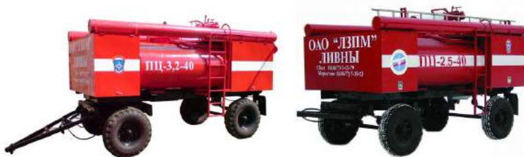
Рис. 2.17. Пожарные прицеп-цистерны ПЦ-2,5-40 (слева) и ПЦ-3,2-40 (справа)
