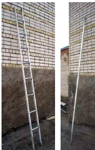
Рис. 5.2.4. Лестница- палка металлическая
