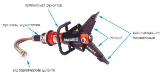
Рис. 5.1.25. Общее устройство гидравлического комбинированного инструмента
