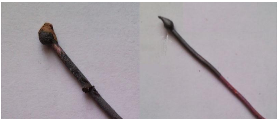
Рисунок 3. Оплавления, вызванные токами короткого замыкания
