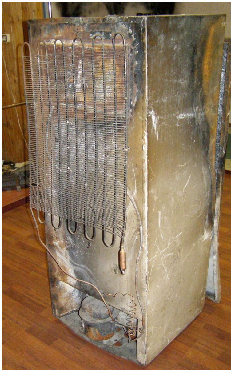
Рисунок 14. Следы аварийной работы на корпусе холодильника
