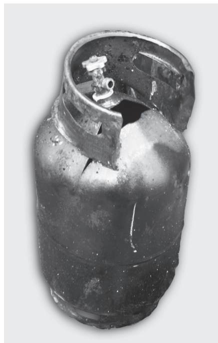
Рис. 13.14. Баллон с пропан-бутаном, взорвавшийся в ресторане «Харбин» (Санкт-Петербург, 2.03.2012 г.)
