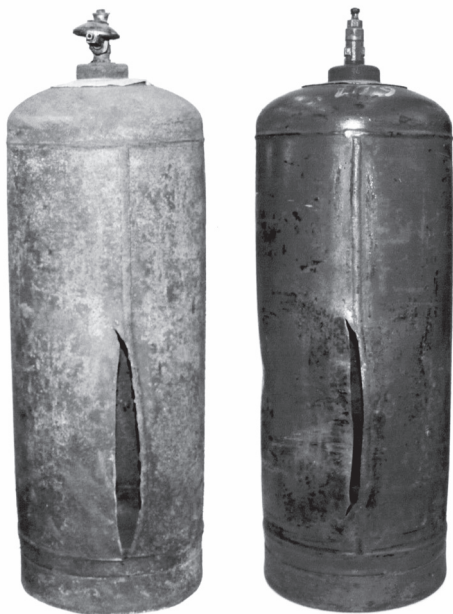
Рис. 13.13. Бытовые газовые баллоны после физического взрыва в результате переполнения при заправке
