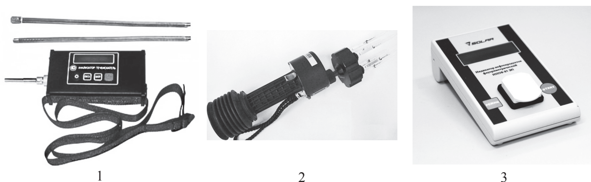
Рис. 14.2. Портативные приборы для обнаружения остатков ЛВЖ (ГЖ) на месте пожара:
