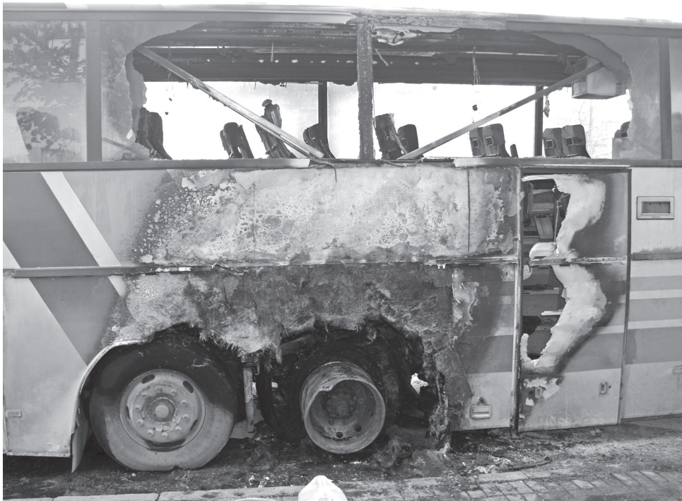
Рис. 15.13. Правый борт туристического автобуса после пожара, возникшего в результате загорания покрышки заднего колеса
