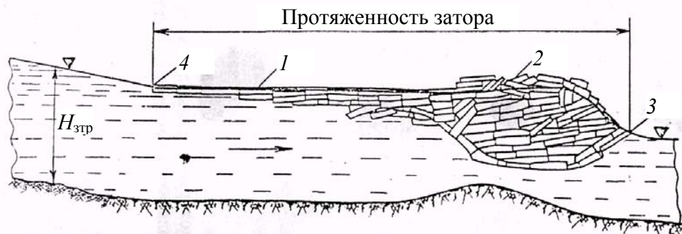
Рис. 7.9. Продольный разрез затора льда:
