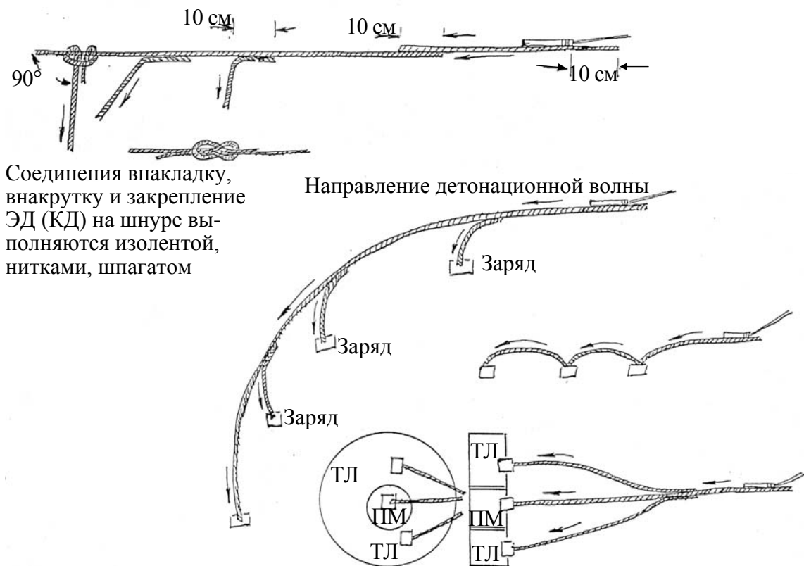
Рис. 7.22. Схемы соединения отрезков ДШ между собой и монтаж взрывной сети
