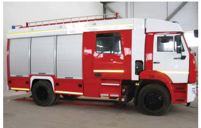
Рис. 5. Пожарная автоцистерна на основе композитных материалов на базе шасси КамАЗ, мод. 43253
