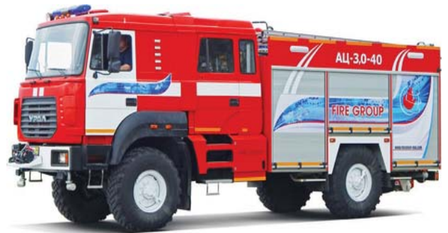
Рис. 3. Новая версия пожарной автоцистерны среднего класса АЦ 3,0-40 (43206-79)
