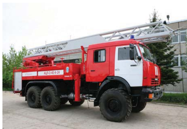
Рис. 13. Автоцистерна пожарная с лестницей АЦЛ 3-40/4-24 (43118)
