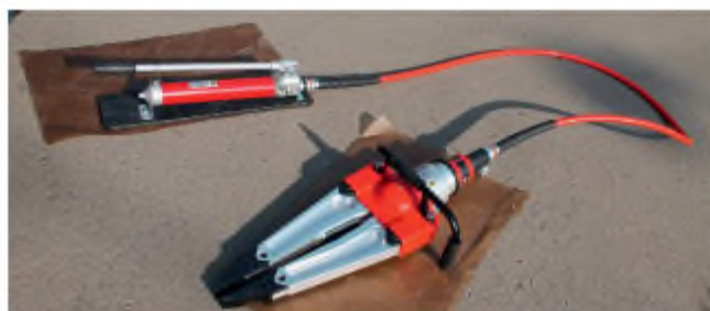
Пример соединения ручного насоса с расширителем
