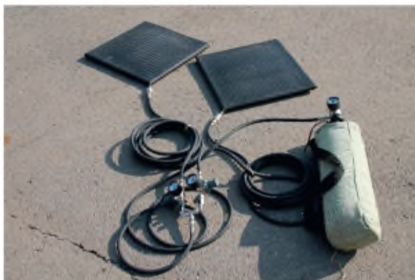
Эластомерный пневмодомкрат с редуктором и баллоном со сжатым воздухом
