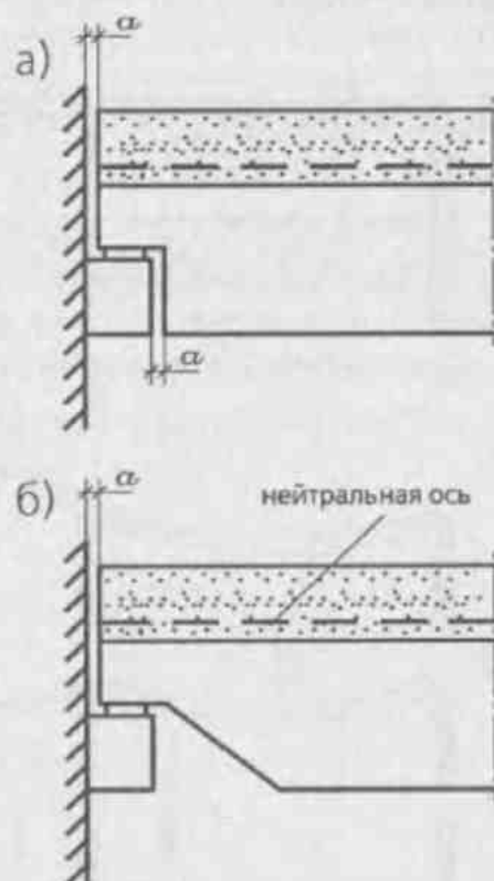
Рис. 6.13. Опоры балок: а - таврового сечения; б - П-образного сечения
