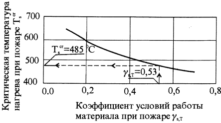
Рис.7.7.Зависимость критической температуры нагрева при пожаре T_s^{cr} стержневой арматуры Ат-V в зависимости от ее коэффициента условий работы при пожаре \gamma_{s,T} (справочные данные разд.9)
