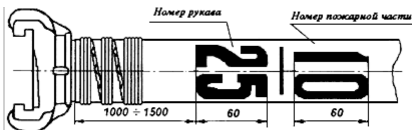
Рис.2. Дополнительная маркировка рукава в пожарной части
