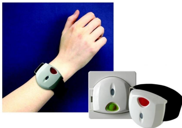
Рис. 3.21. Персональное устройство оповещения о пожаре в виде браслета [111]
