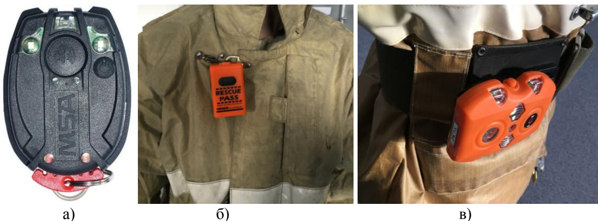
Рис. 3.1. Образцы датчиков неподвижного состояния пожарных а – общий вид; б – закрепление за БОП; в – закрепление на поясе пожарного
