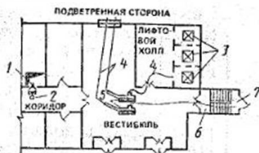
Рис. 18. Схема испытаний установок противодымной защиты
