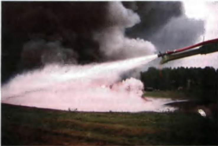
Рис. 10.12. Иллюстрация скоростного напора пенной струи при тушении пожара в амбаре с нефтью
