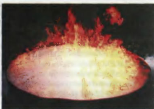
Рис. 10.3. Иллюстрация «прорыва» пара горючего через слой пены
