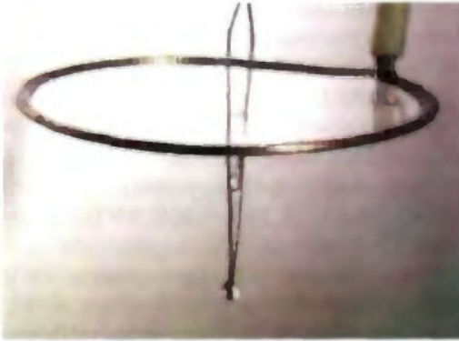
Рис. 5.24. Фрагмент измерительной ячейки для определения электроосмотического переноса жидкости в свободной пленке
