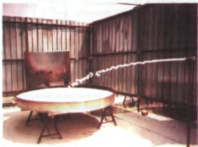
Рис. 5.20. Схема установки для испытания огнетушащей эффективности низкократной пены подачей пены непосредственно на горящую поверхность углеводорода
