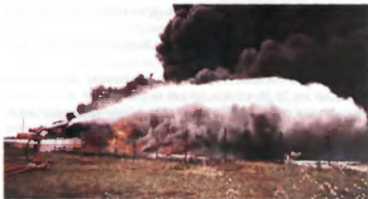
Рис. 1.1. Иллюстрация процесса получения пеноэмульсий для тушения пожаров нефти в амбрах
