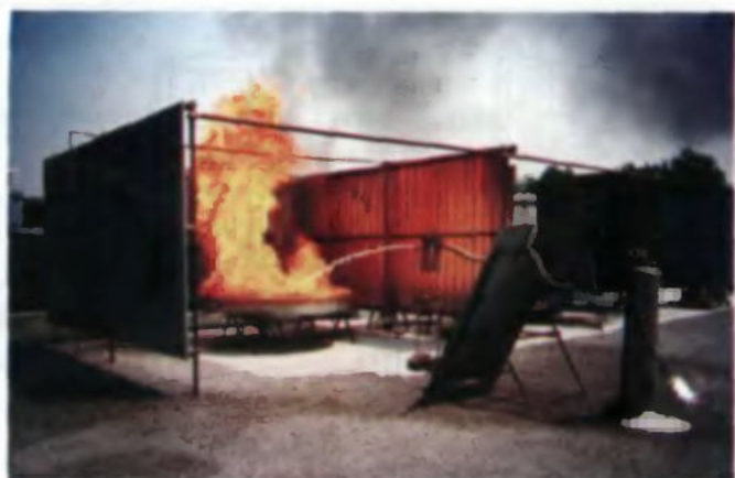
Рис. 5.19. Схема установки для получения низкократной пены и подачи ее в противень с горящим углеводородом
