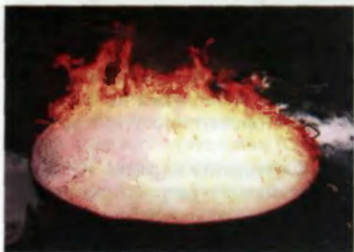
Рис. 10.2. Фрагмент тушения пламени углеводорода низкократной пеной
