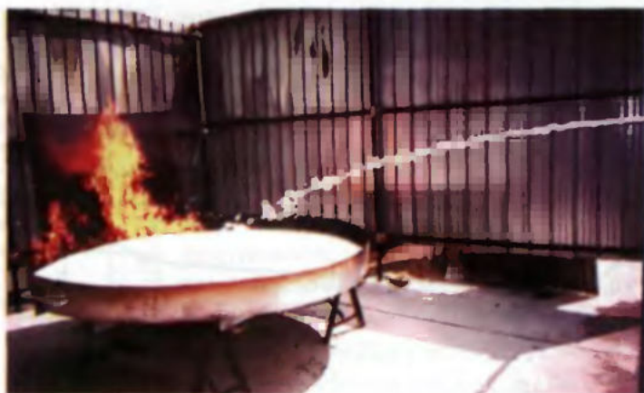
Рис. 10.13. Тушение бензина в стендовых условиях с низким скоростным напором пенной струи
