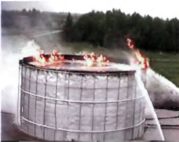
Рис. 10.1. Тушение пожара нефти в резервуаре подачей низкократной фторсинтетической пены в основание резервуара (подслойный способ)
