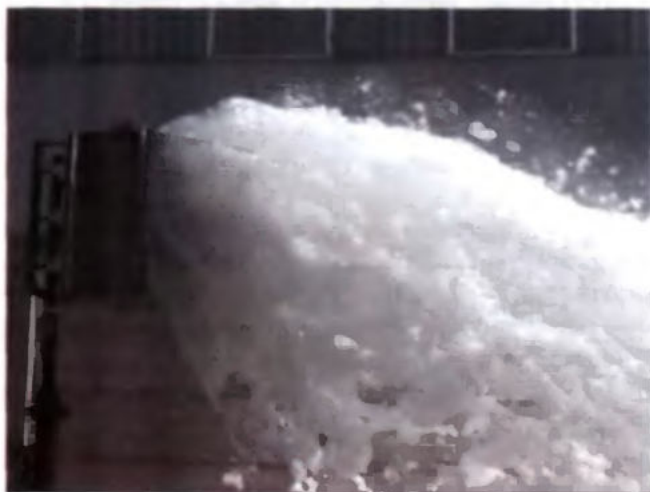
Рис. 10.19. Иллюстрация процесса образования высокократной полидисперсной пены на дымоустойчивых генераторах с многократной эжекцией воздуха
