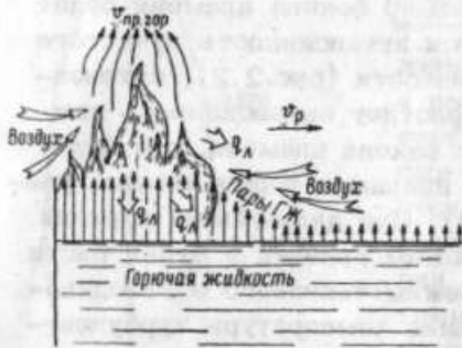
Рис.2.2. Структура диффузионного пламени горючей жидкости
